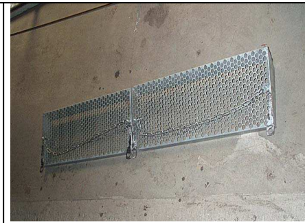
Obersiebrahmen mit hochgestellter Verlängerung + 18x22mm Langloch-Siebe + Ketten AF 1680 -7140
