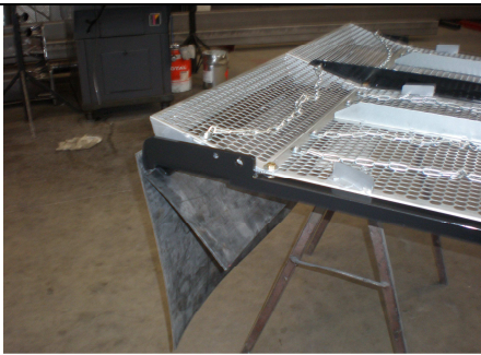
Obersiebrahmen mit hochgestellter Verlängerung + 18x22mm Langloch-Siebe + Ketten AF 1680 -7140
